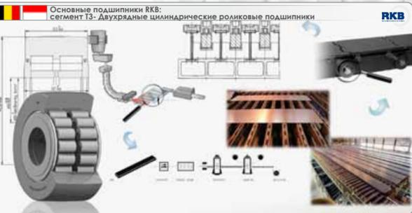
**ПЛОСКАЯ КОНВЕЙЕРНАЯ ЦЕПЬ СТАНА ГОРЯЧЕЙ ПРОКАТКИ**
